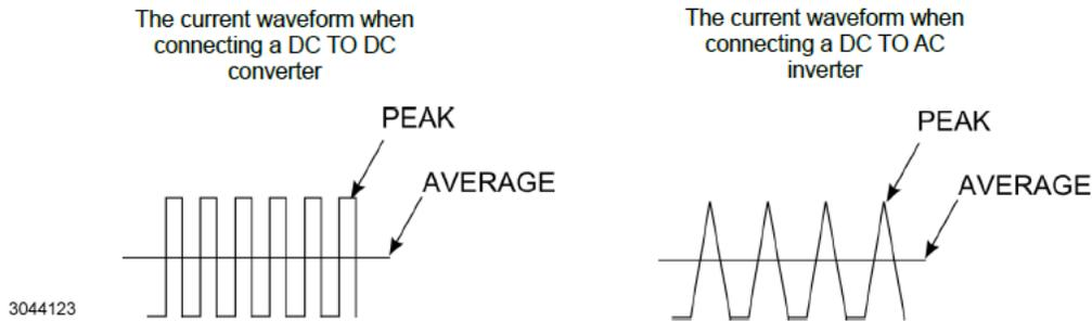
FIGURE 2-17. TYPICAL CURRENT WAVEFORMS FOR PWM LOAD
