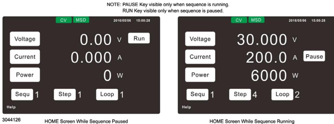
FIGURE 3-15. HOME SCREEN SHOWING SEQUENCE PAUSED AND RUNNING(‡)
