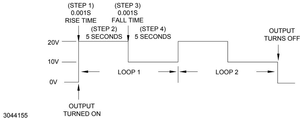
FIGURE 3-11. SEQUENCE EXAMPLE 1, POWER SUPPLY OUTPUT
