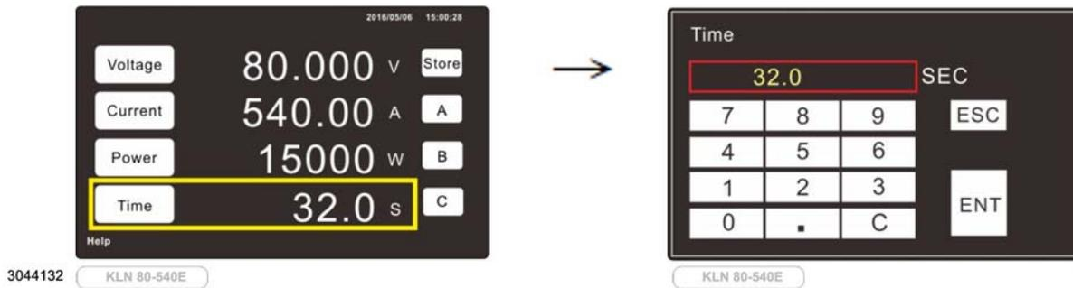
FIGURE 3-6. TOUCHSCREEN SETTING OF OUTPUT ON TIME
