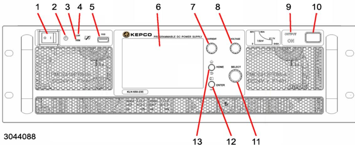
**FIGURE 3-1. KLN EXT SERIES FRONT PANEL<sup>(‡)</sup>**
