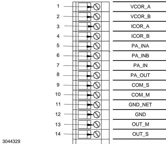
**FIGURE 2-3. BOP CONTROL/ACCESS TERMINAL BLOCK**
