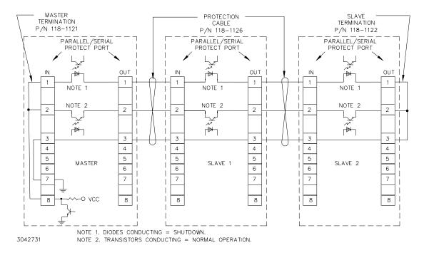
FIGURE 2-8. TYPICAL MASTER/SLAVE PROTECTION INTERCONNECTIONS
