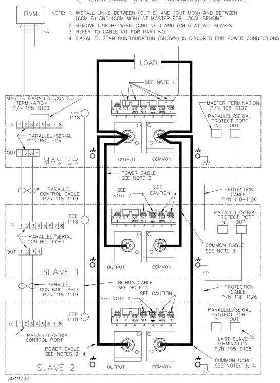
FIGURE 2-4. PARALLEL CONFIGURATION, LOCAL SENSING, TYPICAL
