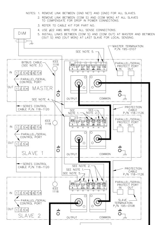
FIGURE 2-6. SERIES CONFIGURATION, LOCAL SENSING, TYPICAL
