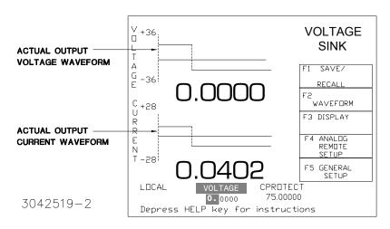
FIGURE 3-4. POWER-UP SCREEN SHOWING TIME LINE GRAPH
