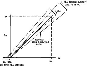
FIG. 3-6 ESTABLISHING PROGRAMMING LINEARITY
