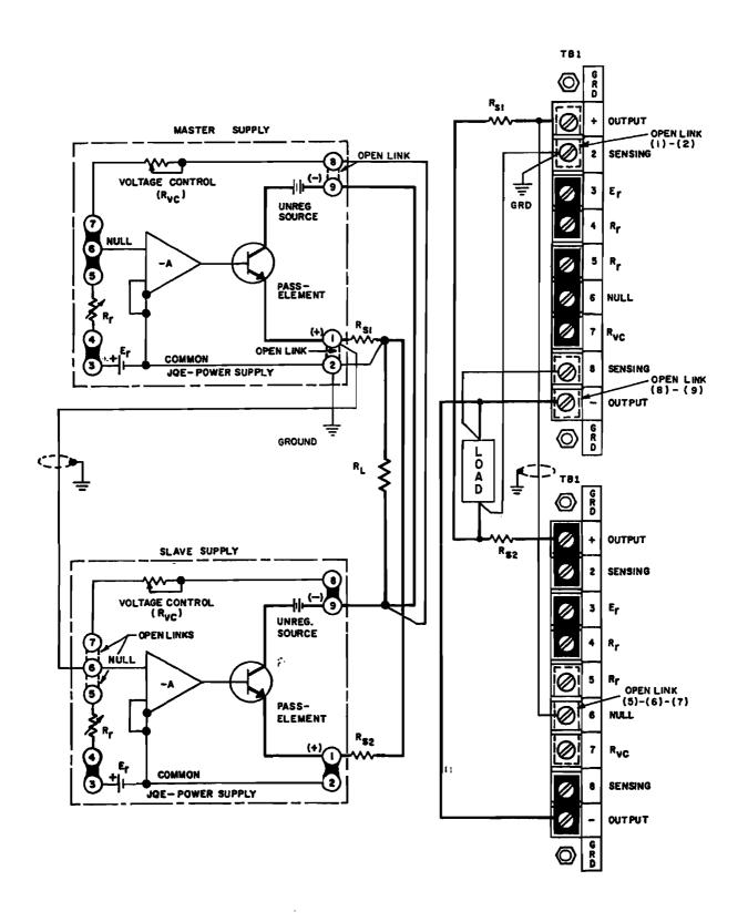
FIG. 3-15 MASTER-SLAVE PARALLEL CONNECTION OF JQE POWER SUPPLIES
