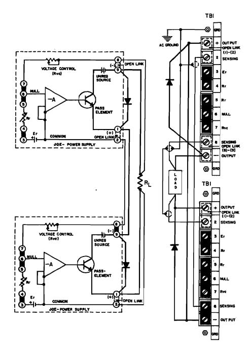
FIG. 3-11 AUTOMATIC SERIES CONNECTION OF JQE POWER SUPPLIES
