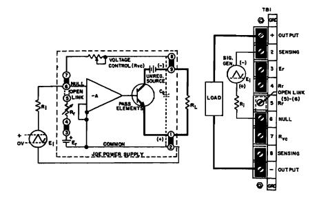
FIG. 3-9 JQE 1/4 Rack IN THE OPERATIONAL AMPLIFIER MODE.
